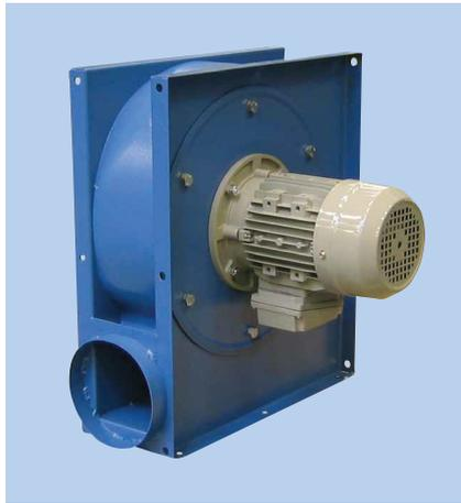
Zentrifugalventilator mit offenem Ventilatorrad, der für Punktabsaugung von verschmutzenden oder spänerzeugenden Arbeitsprozessen angewandt wird. Transportierte Luft darf nicht klebende oder klebrige Dämpfe oder Staub enthalten.
